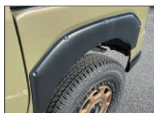
フェンダープロテクター 4ナンバー貨物車では車検NGであるタイヤのサイドウォールはみ出しをカバー。耐久性に優れた AES 製なので塗装なしOK! カンタン両面テープ装着で加工の必要なし。(ダミーボルトオプション ¥2,200 税込) ハイゼットカーゴ・デッキバン フェンダープロテクター 700 系対応 ¥39,000 (¥42,900 税込)
